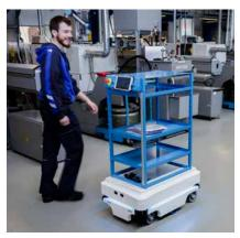
MiR100 kann bis zu 100 kg tragen. Der Roboter bremst und weicht automatisch dynamischen Hindernissen aus.
